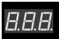
Indicación pulso actual > punto decimal intermitente
