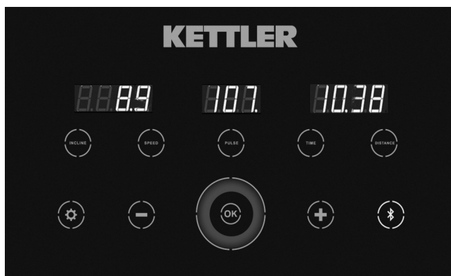
Zobrazení stoupání > INCLINE (jasněji) Zobrazení rychlosti > SPEED (jasněji)
